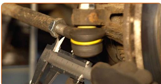
**7** Lösen Sie die Kontermutter des Spurstangenkopf und der Zugstange. Verwenden Sie Ring-Gabelschlüssel Nr. 22.
