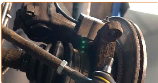
**11** Schrauben Sie das Ende aus der Zugstange.
