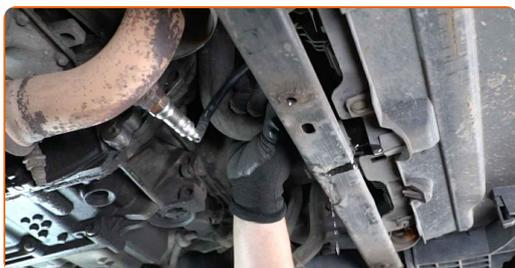
**19** Lassen Sie das Kühlmittel aus dem Motor ab.
