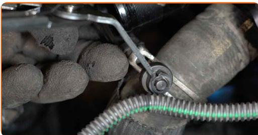
**48** Bringen Sie den Kühlmittelschlauch an.
