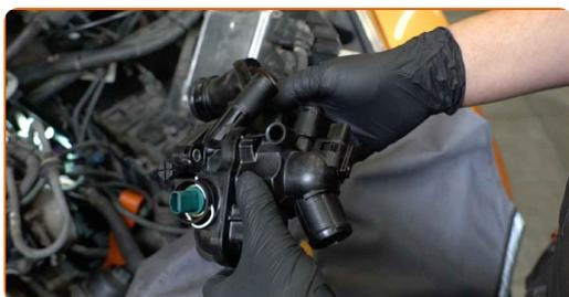
**39** Bringen Sie den Kühlmittelschlauch an.
