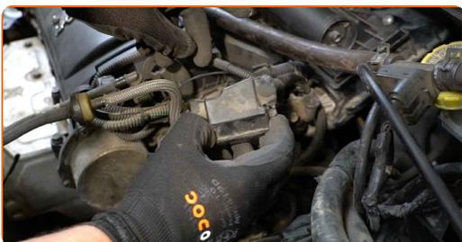
**12** Ziehen Sie die Motorkabelbaumstecker ab. Verwenden Sie einen flachen Schraubendreher.
