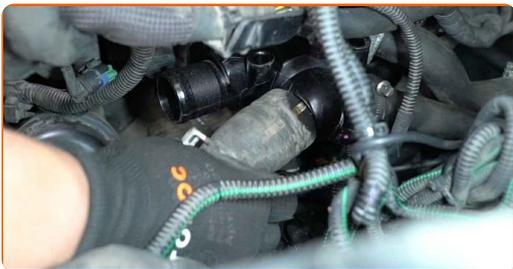
**46** Sichern Sie die Klemme des Kühlmittelschlauchs. Verwenden Sie Stecknuss Nr. 7. Verwenden Sie einen Ratschenschlüssel.
