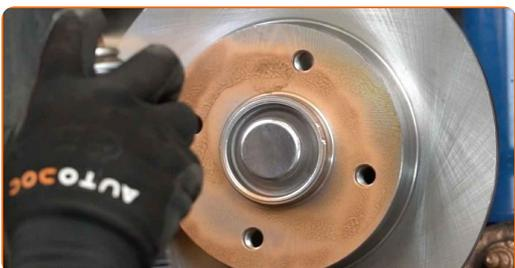
**31** Die Bremsscheibenoberfläche reinigen. Verwenden Sie Allzweckreinigungsspray.
