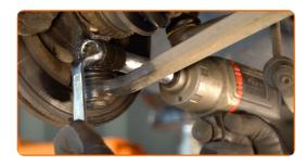
Entfernen Sie die Befestigungsschraube.
