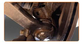
Lösen Sie die Befestigung, die das Kugelgelenk des Querlenkers mit dem Achsschenkel verbindet. Verwenden Sie einen flachen Metallmeißel. Benutzen Sie einen Hammer.
