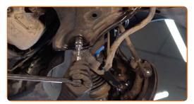
Schrauben Sie die hintere Armbefestigung ab. Verwenden Sie Stecknuss Nr. 21. Verwenden Sie ein Windeisen.
