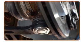
Schrauben Sie die Befestigungen des Kugelgelenks ein. Verwenden Sie Stecknuss Nr. 17. Verwenden Sie Ring-Gabelschlüssel Nr. 17.
