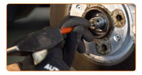
Reinigen Sie das Verbindungselement, welches das Kugelgelenk mit dem Achsschenkel verbindet. Benutzen Sie eine Drahtbürste. Benutzen Sie WD-40-Spray.
