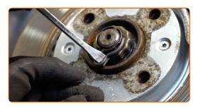
Drehen Sie das Befestigungselement der Antriebswelle auf. Verwenden Sie Stecknuss Nr. 32. Verwenden Sie ein Windeisen. Benutzen Sie ein Brecheisen.
