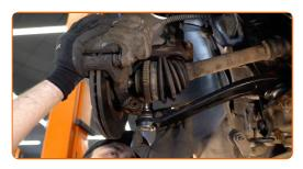
Verbinden Sie den Unterarm mit dem Achsschenkel.
