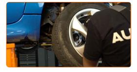
Reinigen Sie das Befestigungselement der Antriebswelle. Benutzen Sie eine Drahtbürste.
