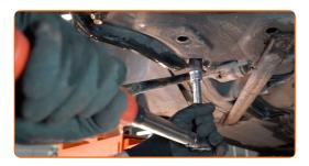
Ziehen Sie das Kugelgelenk an. Verwenden Sie Ring-Gabelschlüssel Nr. 17. Verwenden Sie Stecknuss Nr. 17. Verwenden Sie einen Drehmomentschlüssel. Ziehen Sie ihn mit 40 Nm Drehmoment fest.
