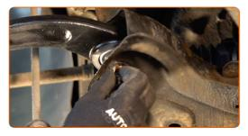
Schrauben Sie die vordere Armbefestigung an. Verwenden Sie Ring-Gabelschlüssel Nr. 21. Verwenden Sie Stecknuss Nr. 21.
