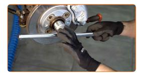
Trennen Sie die Antriebswelle vom Achsschenkel. Verwenden Sie einen Splintentreiber. Benutzen Sie einen Hammer.
