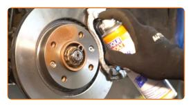
Die Bremsscheibenoberfläche reinigen. Benutzen Sie einen Bremsenreiniger.
