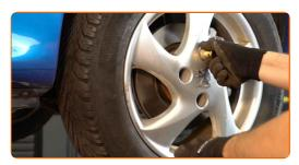
Senken Sie das Auto und ziehen Sie die Radschrauben über Kreuz an. Verwenden Sie einen Drehmomentschlüssel. Ziehen Sie ihn mit 100 Nm Drehmoment fest.
