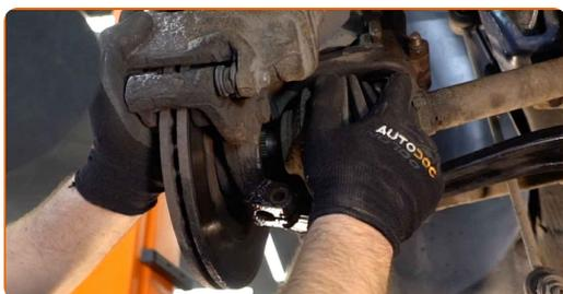
**61** Verbinden Sie den Unterarm mit dem Achsschenkel.
