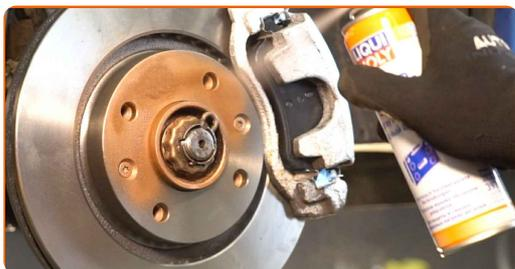
**72** Die Bremsscheibenoberfläche reinigen. Benutzen Sie einen Bremsenreiniger.
