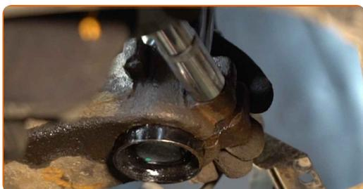
**57** Ziehen Sie die Befestigungsklammer des Bremsschlauchs am Federbein an. Verwenden Sie Stecknuss Nr. 13. Verwenden Sie einen Ratschenschlüssel.
