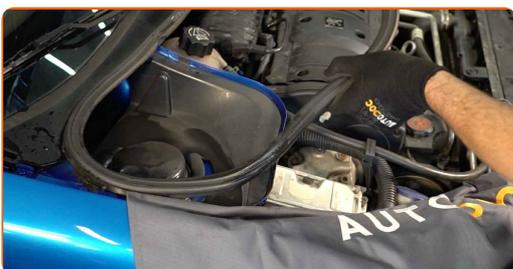
**4** Entfernen Sie die Kappe des Federbeinstützlagers.
