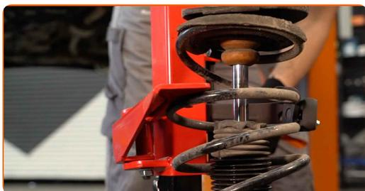
**37** Behandeln Sie die Federbeinstange. Benutzen Sie eine Drahtbürste. Benutzen Sie WD-40-Spray.
