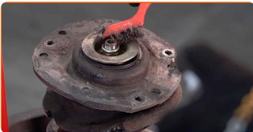
**38** Entfernen Sie die Stangenmutter des Federkolben. Verwenden Sie Stecknuss Nr. 21. Verwenden Sie Inbusschlüssel Nr. H7. Verwenden Sie einen Ratschenschlüssel.
