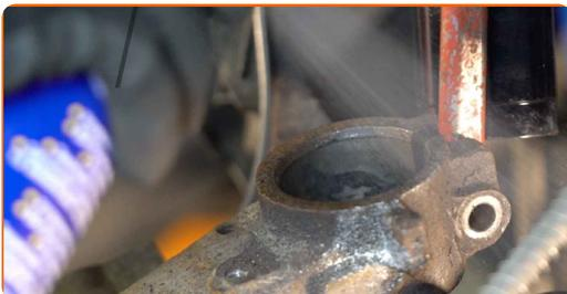
**54** Befestigen Sie das Dämpferbein auf dem Achsschenkel.
