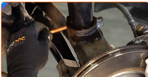
**56** Schrauben Sie das Befestigungselement ein, das das Federbein mit dem Achsschenkel verbindet. Verwenden Sie Stecknuss Nr. 18.
