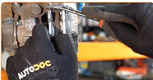
**8** Entfernen Sie die Haltefeder des Bremsbelags. Verwenden Sie eine Rundzange.
