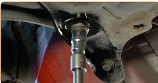
**17** Lösen Sie die hintere Befestigung des Querlenkers. Verwenden Sie Stecknuss Nr. 17.
