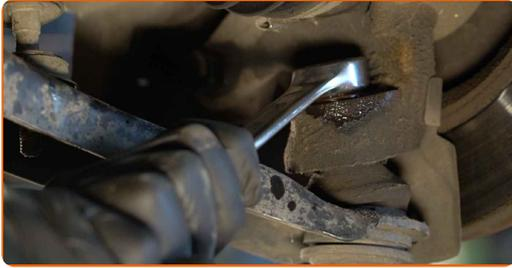
**12** Ziehen Sie den unteren Arm vom Achsschenkel ab. Verwenden Sie einen Kugelgelenkabzieher.
