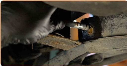
**16** Schrauben Sie das hintere Befestigungselement heraus, das den Querlenker mit dem Hilfsrahmen verbindet. Verwenden Sie Stecknuss Nr. 17. Verwenden Sie ein Windeisen.
