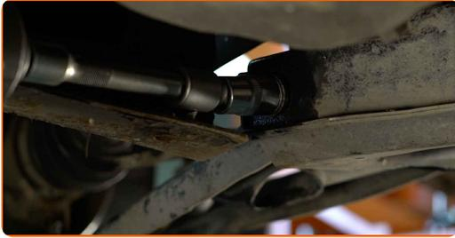
**15** Entfernen Sie die vordere Befestigung des Querlenkers. Verwenden Sie Stecknuss Nr. 17.
