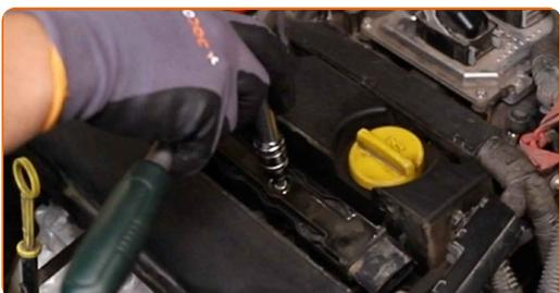
**6** Heben Sie die Zündspule an. Benutzen Sie ein Brecheisen.
