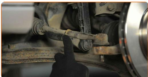
**11** Lösen Sie die Kontermutter des Spurstangenkopf und der Zugstange. Verwenden Sie Ring-Gabelschlüssel Nr. 22.
