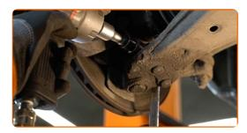
Entfernen Sie die Befestigungsschraube.
