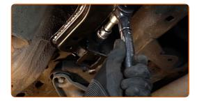
Ziehen Sie das vordere Befestigungselement an, das den Querlenker mit dem Hilfsrahmen verbindet. Verwenden Sie Stecknuss Nr. 18. Verwenden Sie einen Drehmomentschlüssel. Ziehen Sie ihn mit 100 Nm Drehmoment fest.
