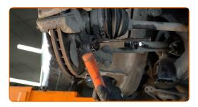
Installieren Sie den Arm. Verwenden Sie einen Gummi-Hammer. Benutzen Sie ein Brecheisen.
