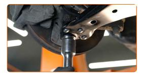
Schrauben Sie die Befestigungen des Kugelgelenks ein. Verwenden Sie Ring-Gabelschlüssel Nr. 18. Verwenden Sie Stecknuss Nr. 18. Verwenden Sie einen Ratschenschlüssel.
