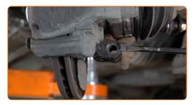
Entfernen Sie die vordere Befestigung des Querlenkers.
