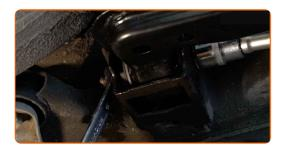
Schrauben Sie die hinteren Befestigungen, welche den Querlenker mit dem Karosseriehilfsrahmen verbinden, fest. Verwenden Sie Stecknuss Nr. 18. Verwenden Sie einen Drehmomentschlüssel. Ziehen Sie ihn mit 100 Nm Drehmoment fest.
