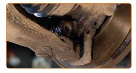
Schrauben Sie die vordere Armbefestigung ab. Verwenden Sie Ring-Gabelschlüssel Nr. 18. Verwenden Sie Stecknuss Nr. 18. Verwenden Sie einen Ratschenschlüssel.
