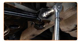
Ziehen Sie das Kugelgelenk an. Verwenden Sie Ring-Gabelschlüssel Nr. 18. Verwenden Sie Stecknuss Nr. 18. Verwenden Sie einen Drehmomentschlüssel. Ziehen Sie ihn mit 75 Nm Drehmoment fest.
