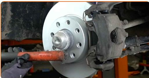
**34** Behandeln Sie die Oberfläche, an der die Bremsscheibe die Felge berührt. Verwenden Sie Hochtemperatur-Keramikfett.
