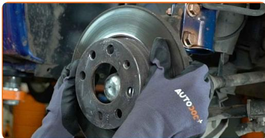
Austausch: Bremsscheiben – OPEL Vectra A Limousine (J89). Tipp von AUTODOC:
