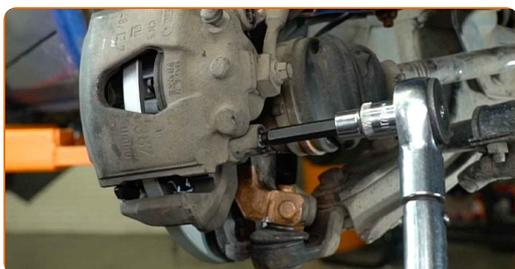
**31** Installieren Sie die Staubschutzkappen der Bremssattel-Führungsstifte.
