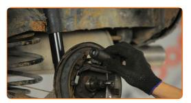
Schrauben Sie die Befestigung des Radzylinders fest. Verwenden Sie Stecknuss Nr. 10. Verwenden Sie einen Drehmomentschlüssel. Ziehen Sie ihn mit 10 Nm Drehmoment fest.
