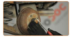
Entfernen Sie den Sicherungssplint, der die Nabenmutter sichert. Verwenden Sie eine Rundzange.
