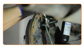
Nehmen Sie den Bremszylinder von der Rückplatte ab. Benutzen Sie ein Brecheisen.
