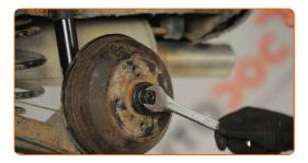
Installieren Sie den Splint der Nabe an der Lagerbefestigungsmutter. Verwenden Sie eine Rundzange.
