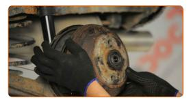
Schrauben Sie die Befestigung der Radnabe ein. Verwenden Sie Ring-Gabelschlüssel Nr. 24. Verwenden Sie einen Ratschenschlüssel.
