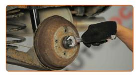
9 Entfernen Sie die Bremstrommel.
