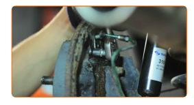
Bringen Sie die Bremsleitung an. Verwenden Sie einen offenen Ringschlüssel #10.
