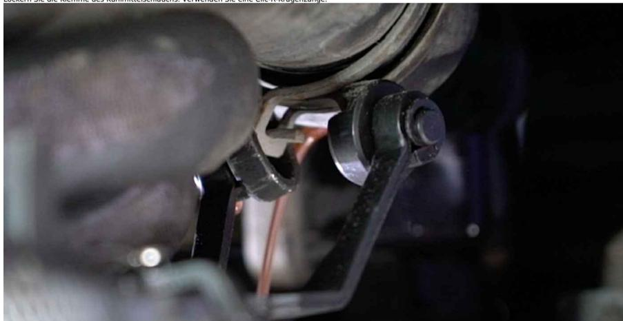
8 Lösen Sie den Kühlmittelschlauch.
