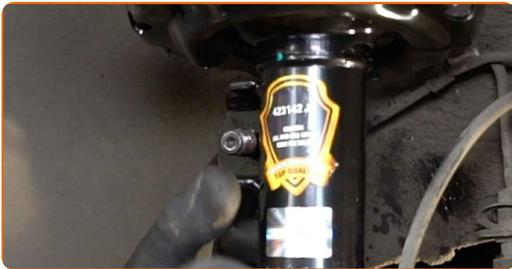
**60** Ziehen Sie das Befestigungselement an, das die Druckstange mit dem Federbein verbindet. Verwenden Sie Stecknuss Nr. 19. Verwenden Sie einen Drehmomentschlüssel. Ziehen Sie ihn mit 55 Nm Drehmoment fest.
