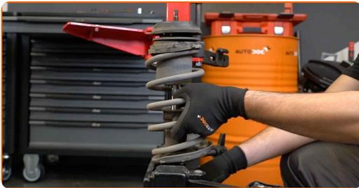
**Austausch: Federbein – OPEL Corsa Utility Pickup. Tipp von AUTODOC:**
