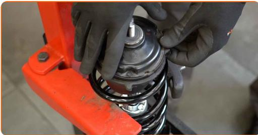
**46** Ziehen Sie die Federbeinkolbenstangenmutter an. Verwenden Sie einen Stoßdämpfer Steckschlüsseinsatz №DD9. Verwenden Sie Ring-Gabelschlüssel Nr. 18. Verwenden Sie einen Drehmomentschlüssel. Ziehen Sie ihn mit 50 Nm Drehmoment fest.
