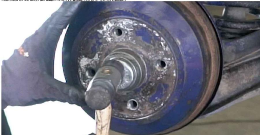
54 Behandeln Sie die Oberfläche, an die Radfelge die Bremstrommel berührt. Verwenden Sie Keramikfett.
