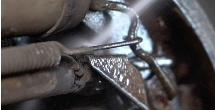
13 Lösen Sie den Nachsteller der Bremsbacken. Benutzen Sie ein Brechheisen.
