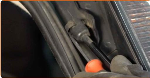
**Austausch: Heckklappendämpfer – OPEL Corsa C Kastenwagen (X01).
