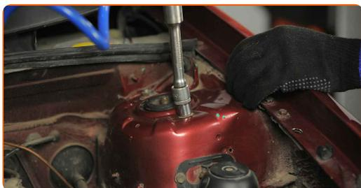
**Austausch: Domlager – OPEL Corsa B Kastenwagen (S93). Tipp von AUTODOC-Experten:**
