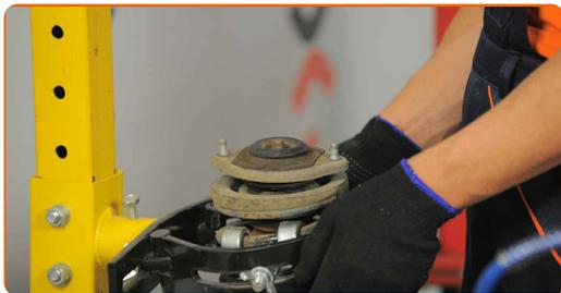
**18** Behandeln Sie die Federbeinstange. Benutzen Sie eine Drahtbürste. Benutzen Sie WD-40-Spray.
