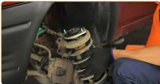
**26** Schrauben Sie die obere Befestigung des Domlagers an.
