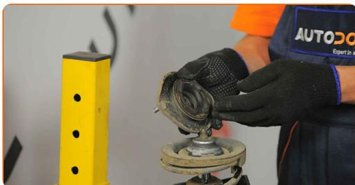
**Austausch: Domlager – OPEL Corsa B Kastenwagen (S93). Tipp:**
