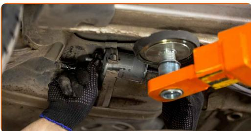
**Austausch: Kraftstofffilter – OPEL Corsa A Kastenwagen (S83). Tipp:**
