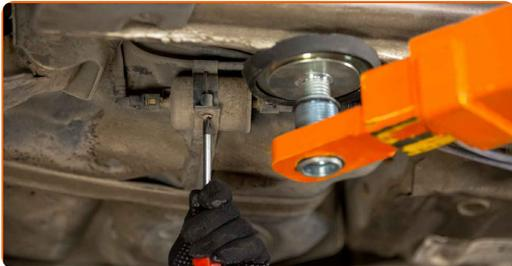
**3** Drücken Sie die Clips zusammen und lösen Sie die Kraftstoffzufuhrleitungen vom Kraftstofffiltergehäuse. Verwenden Sie Kraftstoffleitungsanzangen.
