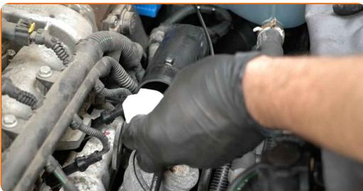
**8** Lösen Sie die Steckverbinder der Glühkerzenverkabelung.
