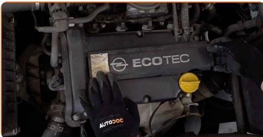
**3** Ziehen Sie den Anschluss der Zündspule ab. Verwenden Sie einen flachen Schraubendreher.
