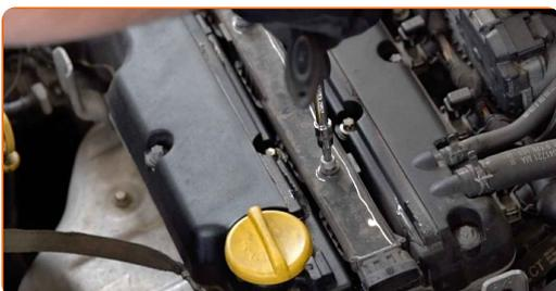
**5** Heben Sie die Zündspule an. Benutzen Sie ein Brecheisen.
