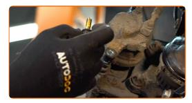
Entfernen Sie den Bremssattel.
