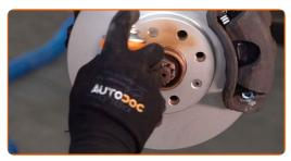
Die Bremsscheibenoberfläche reinigen. Benutzen Sie einen Bremsenreiniger.
