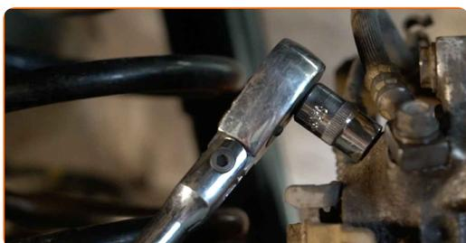
**29** Verbinden Sie den Schlauch des Bremsentlüftungs-Kits mit der Bremsentlüftungsschraube.
