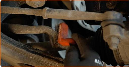
**12** Montieren Sie den Querlenker.
