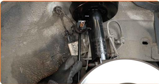
**13** Ziehen Sie die Befestigungselemente des Stabilenkers fest. Verwenden Sie Ring-Gabelschlüssel Nr. 18.
