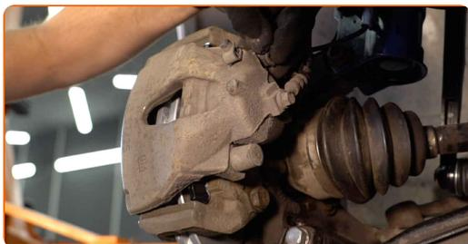
**20** Lassen Sie die Bremssattel-Haltefeder wieder an der Ursprungsposition einrasten. Benutzen Sie ein Brecheisen.
