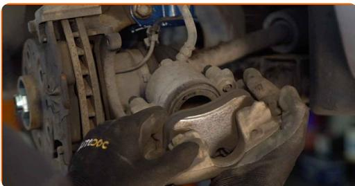
**Austausch: Bremsbeläge – OPEL Astra H Schrägheck (A04). Tipp von AUTODOC:**
