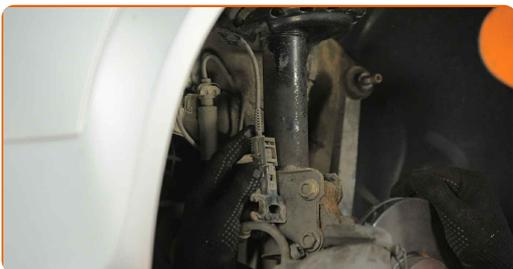
**43** Befestigen Sie den Bremsschlauch an der Strebe.
