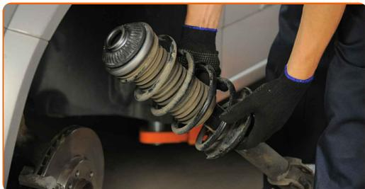
**33** Schrauben Sie die obere Befestigung des Federbeinbefestigung an. Verwenden Sie eine Wasserpumpenzange.
