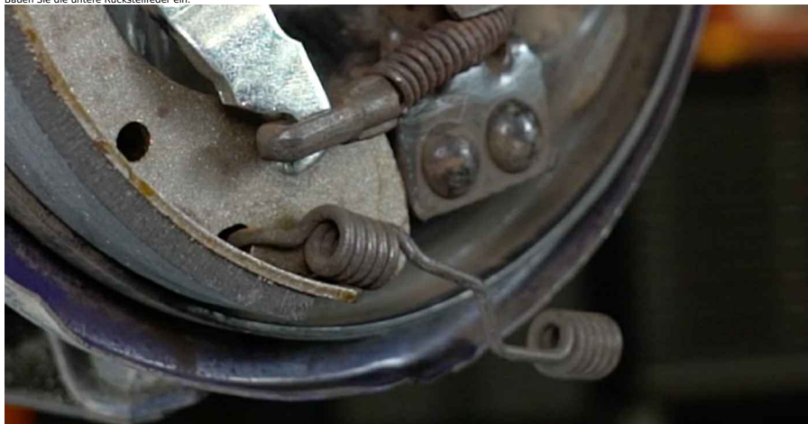
26 Entfernen Sie die obere Feder und den Verstellmechanismus.
