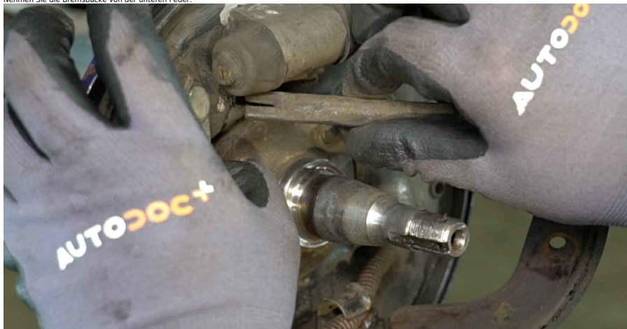
18 Entfernen Sie die rechte Bremsbacke.
