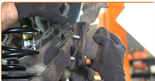
**25** Reinigen Sie den Einbauort für die Nabenlager. Benutzen Sie eine Drahtbürste. Benutzen Sie WD-40-Spray.
