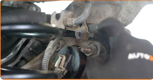
**35** Schrauben Sie die Befestigung der Halterung des ABS-Kabelbaums fest. Verwenden Sie Stecknuss Nr. E8. Verwenden Sie einen Drehmomentschlüssel. Ziehen Sie ihn mit 7 Nm Drehmoment fest.
