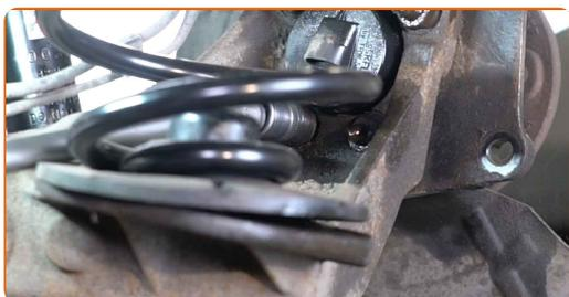
**22** Lösen Sie die Befestigung der Halterung des ABS-Kabelbaums. Verwenden Sie Stecknuss Nr. E8. Verwenden Sie einen Ratschenschlüssel.
