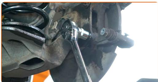
**14** Entfernen Sie die Sattelhalterung.
