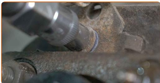
**23** Entfernen Sie die Halterung des ABS-Kabelbaums.
