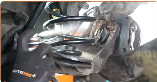
**38** Behandeln Sie die Radnabe an der Kontaktstelle mit der Brems Scheibe. Benutzen Sie ein Kupferschmiermittel.
