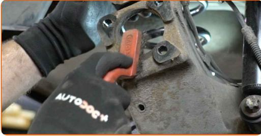
**26** Lösen Sie das Nabenlager vom Schutzblech der Bremsscheibe. Benutzen Sie einen Hammer.
