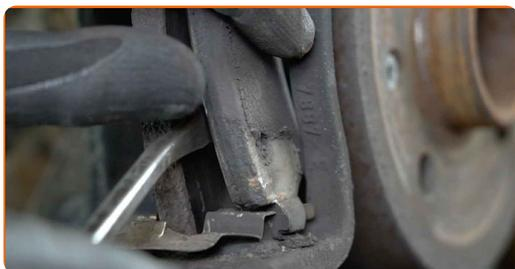
**12** Die Befestigungselemente der Bremssattelhalterung reinigen. Benutzen Sie eine Drahtbürste. Benutzen Sie einen Bremsenreiniger.
