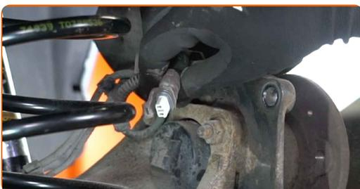
**20** Reinigen Sie die Befestigungen des Radnabenlagers. Benutzen Sie eine Drahtbürste. Benutzen Sie WD-40-Spray.
