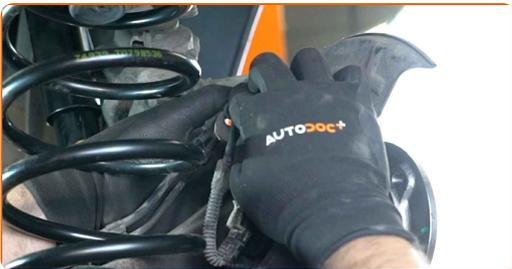
**37** Behandeln Sie die Befestigungen des Radnabenlagers. Benutzen Sie ein Kupferschmiermittel.
