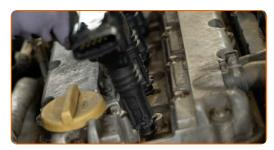
Schrauben Sie die Schrauben der Zündspule fest. Verwenden Sie den Torx T30. Verwenden Sie einen Drehmomentschlüssel. Ziehen Sie ihn mit 7 Nm Drehmoment fest.
