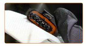
Schließen Sie den Anschluss der Zündspule an.
