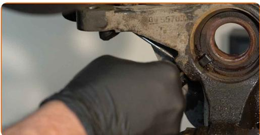
**38** Entfernen Sie den Sicherungsring am Radnabenlager. Benutzen Sie ein Brecheisen. Benutzen Sie einen Hammer.
