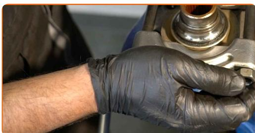
**35** Reinigen Sie die Befestigung des ABS-Sensors. Benutzen Sie eine Drahtbürste. Benutzen Sie WD-40-Spray.
