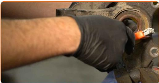
**36** Schrauben Sie die Befestigung des ABS-Sensors ab. Verwenden Sie Inbusschlüssel Nr. H5. Verwenden Sie einen Ratschenschlüssel.
