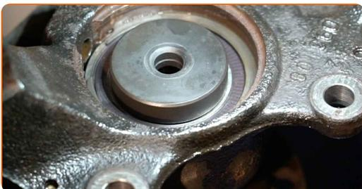
**46** Installieren Sie den Achsschenkel mit einer Nabe.
