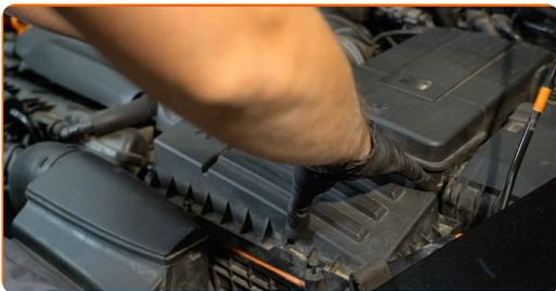
**11** Drehen Sie die Befestigungsschrauben der Luftfilter-Abdeckung ein. Verwenden Sie einen Kreuzschlitzschraubendreher.
