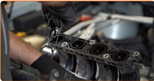
23 Die neue Ansaugkrümmerdichtung einbauen.
