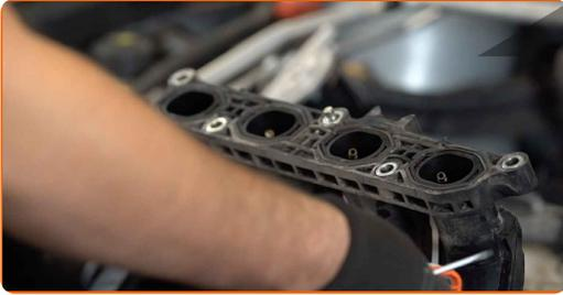
22 Die Ansaugkrümmerdichtung entfernen. Verwenden Sie einen flachen Schraubendreher.
