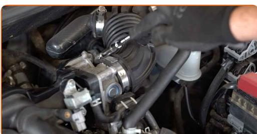
**5** Trennen Sie das Luftansaugrohr vom Luftfilter-Gehäuse.
