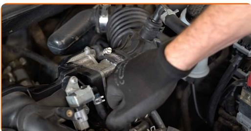
**4** Lösen Sie die Klemmen und Befestigungselemente am Luftfilter-Ansaugrohr. Verwenden Sie Stecknuss Nr. 10. Verwenden Sie einen Ratschenschlüssel.
