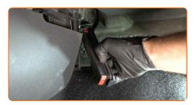
Entfernen Sie das Filterelement aus dem Filtergehäuse.
