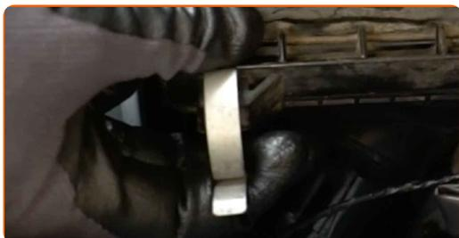
**4** Heben Sie die Abdeckung des Luftfiltergehäuses leicht an.
