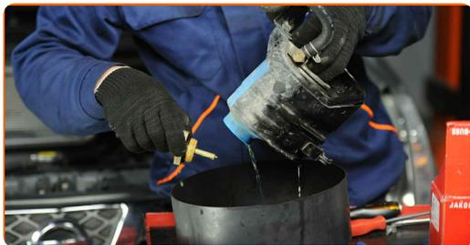
**15** Entfernen Sie den Kraftstofffilter.
