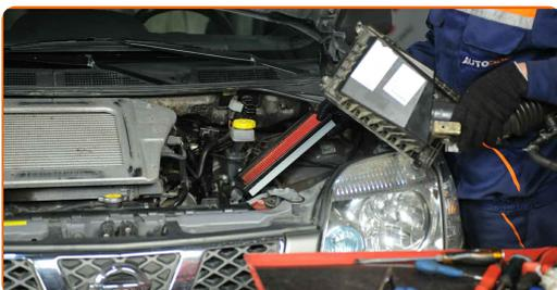
**28** Setzen Sie die Luftfilterabdeckung ein. Befestigen Sie diese.
