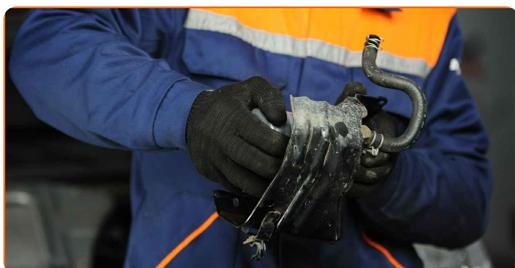
**18** Installieren Sie einen neuen Kraftstofffilter.
