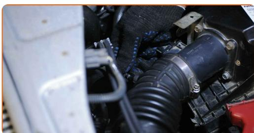
**31** Verbinden Sie den Schlauch der Kurbelgehäuseentlüftung mit dem Lüftungsrohr.
