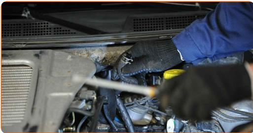
Austausch: Kraftstofffilter – NISSAN SUNNY II Hatchback (N13). AUTODOC-Experten empfehlen:
