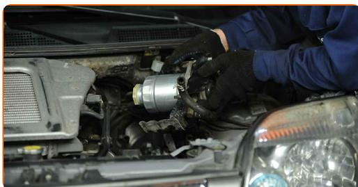
**23** Bringen Sie die Schläuche am Kraftstofffilter an. Verwenden Sie Zangen.
