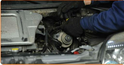
**11** Reinigen Sie die Befestigungen der Kraftstoff-Zuleitungen. Verwenden Sie Allzweckreinigungsspray.
