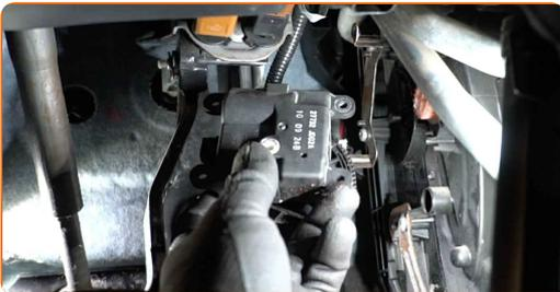
**9** Lösen Sie den Steckverbinder des Heizungsstellmotors.
