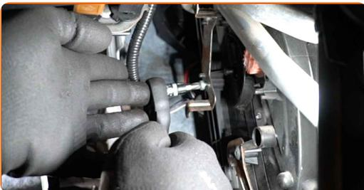
**11** Entfernen Sie die Halterung des Heizungsstellmotors.
