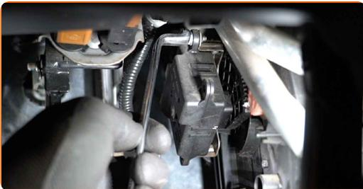
**8** Entfernen Sie den Heizungsstellmotor.
