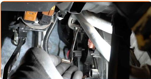
**12** Entfernen Sie den Gehäusedeckel des Innenraumfilters.
