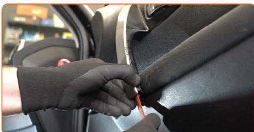
**3** Schrauben Sie die Befestigung des Türgriffs ab. Verwenden Sie Stecknuss Nr. 10. Verwenden Sie einen Ratschenschlüssel.
