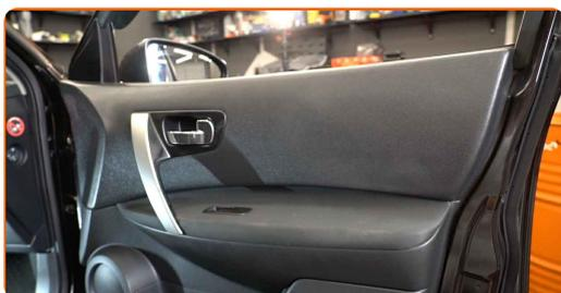
**2** Lösen Sie die Türgriffverkleidung. Verwenden Sie einen Zierleistenkeil.
