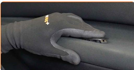
**46** Bringen Sie den Steckverbinder des elektrischen Fensterhebers am Schaltmodul an.
