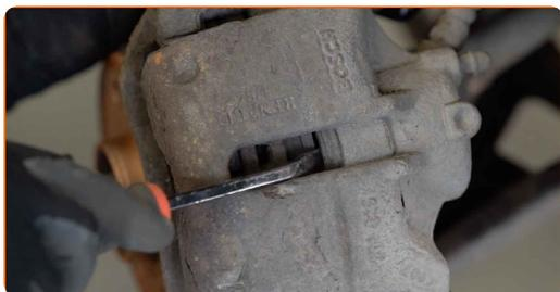
**8** Die Bremssattelbefestigungen reinigen. Benutzen Sie eine Drahtbürste. Benutzen Sie WD-40-Spray.
