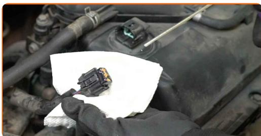
**42** Befestigen Sie die Stecker an der Motorabdeckung. Verwenden Sie einen flachen Schraubendreher.
