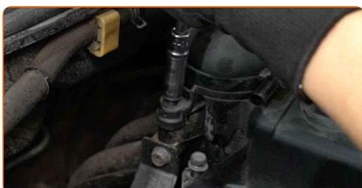
**40** Befestigen Sie die Schläuche an der Motorabdeckung und sichern Sie sie mit den Schellen. Verwenden Sie eine Spitzzange.
