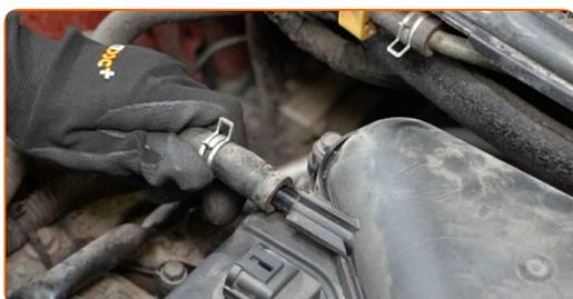
**41** Sprühen Sie die Stecker der Motorabdeckung ein. Verwenden Sie dielektrisches Fett.
