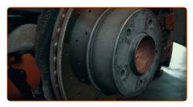
Tragen Sie ein Korrosionsschutzmittel auf
