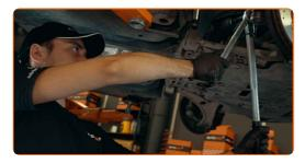
Tragen Sie auf die Schraubverbindungen ein Korrosionsschutzmittel auf
