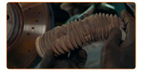
Reinigen Sie die Zahnstangenwelle von altem Schmierfett und Schmutz und tragen Sie neues Fett auf
