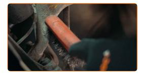
Messen Sie den Abstand vom Anfang des Gewindes der Spurstange bis zum Spurstangenkopf, nicht bis zur Kontermutter
