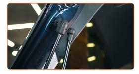
Das Befestigungsteil verfügt über einen Metallclip. Hebeln Sie diesen mit einem Schlitzschraubendreher heraus
