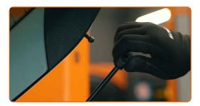
Überprüfen Sie, ob die Gasdruckdämpfer ordnungsgemäß funktionieren
