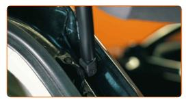
Drücken Sie die Gasdruckdämpfer auf den Kugelzapfen
