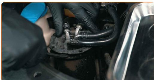
**24** Entfernen Sie den Deckel und nehmen Sie den Filtereinsatz heraus
