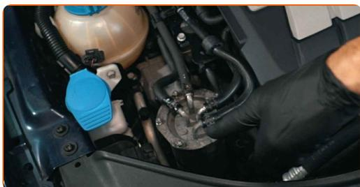
**23** Hebeln Sie den Deckel des Kraftstofffilters vorsichtig mit einem geeigneten Werkzeug ab
