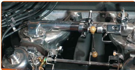
**16** Eine eingebaute Entlüftungspumpe
