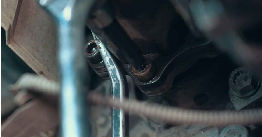
11 Bauen Sie eine neue Antriebswelle ein
