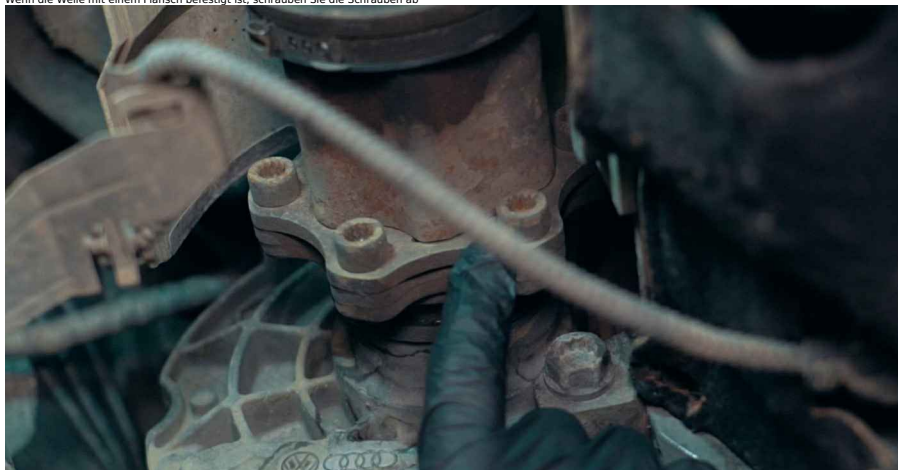
8 Wenn die Welle mit einem Flansch befestigt ist, schrauben Sie die Schrauben ab
