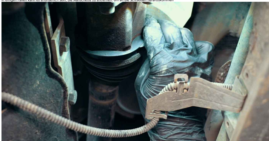
9 In einigen Fällen kann es erforderlich sein, die Manschette zu entfernen, um an die Schrauben heranzukommen
