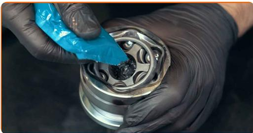
**14** Kippen Sie das Gelenk in verschiedene Richtungen, um das Schmiermittel gleichmäßig zu verteilen
