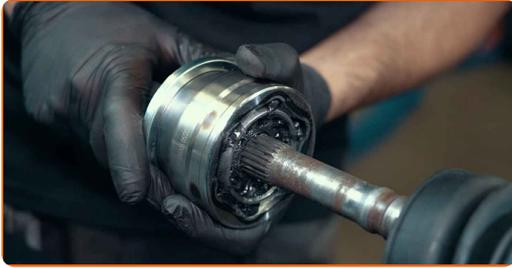
**19** Stellen Sie sicher, dass das Gleichlaufgelenk und die Antriebswelle aufeinander ausgerichtet sind
