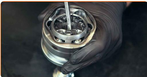
**15** Entfetten Sie die Kontaktfläche der Achsmanschette auf der Antriebswelle
