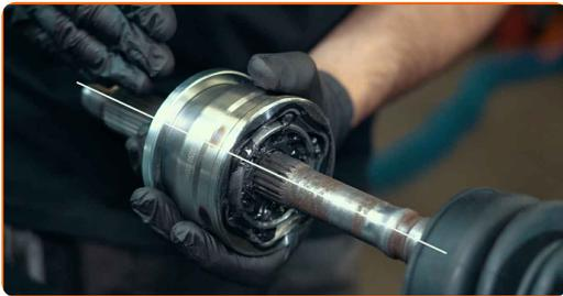
**20** Üben Sie mit einer verlängerten Druckbuchse Kraft auf das Gelenkstück aus
