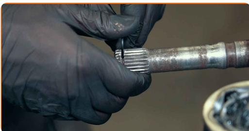
**18** Setzen Sie das Gleichlaufgelenk auf das Ende der Antriebswelle
