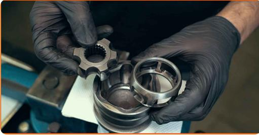
**37** Merken Sie sich die Position der Kugelnabe zum Kugelkäfig und wo sich der Sicherungsring befunden hat
