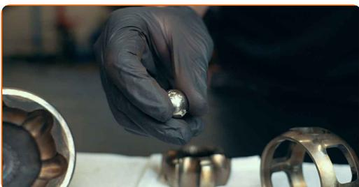
**20** Vergewissern Sie sich, dass die Fenster des Käfigs keine Anzeichen von Abnutzung aufweisen
