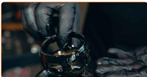
**16** Beurteilen Sie, wie abgenutzt die Laufflächen der Kugeln im Gelenkstück sind
