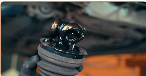
**48** Entfernen Sie den Sicherungsring vorne am Gleichlaufgelenk
