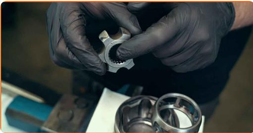
**38** Tragen Sie das meiste Schmierfett innen im Gleichlaufgelenk auf, während Sie es gleichzeitig mit dem Finger verteilen und das Gelenk einschmieren
