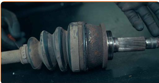
**35** Nehmen Sie hierfür einen Abzieher und die Achsmutter, um das Gleichlaufgelenk von der Achswelle zu lösen
