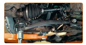
In den meisten Fällen müssen Sie den Lenker aufbocken, bis er fast waagerecht ist. Dieser Arbeitsschritt kann mit Hilfe eines Wagenhebers und einer Stütze durchgeführt werden
