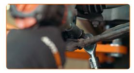
Schrauben Sie die Bolzen und Muttern der Buchsen ganz ab und bauen Sie den Lenker aus
