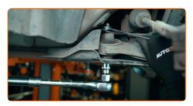
Schrauben Sie den Bolzen und die Mutter des Traggelenks ab und lösen Sie das Traggelenk vom Achsschenkel
