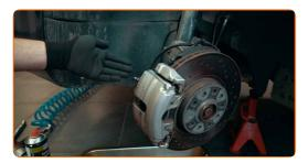
Verwenden Sie ein Bremsenentlüftungsgerät
