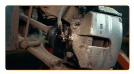
Halten Sie eine Auffangwanne bereit und schrauben Sie das Befestigungselement ab
