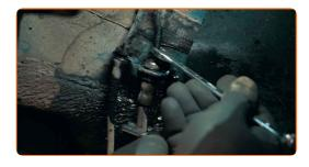
Entfernen Sie den alten Bremsschlauch aus der Halterung
