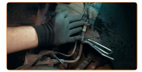
Lösen Sie den Bremsschlauch durch leichtes Drehen aus seiner Halterung.
