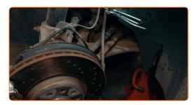
Schrauben Sie die Hohlschraube der Bremsleitung mit einem geeigneten Werkzeug ab
