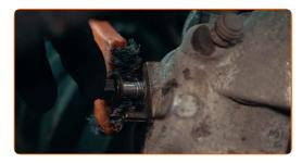
Bauen Sie den Bremsschlauch ein. Verwenden Sie neue Dichtungsscheiben
