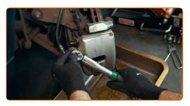
Setzen Sie die Schutzkappe wieder auf und füllen Sie Bremsflüssigkeit in den Behälter
