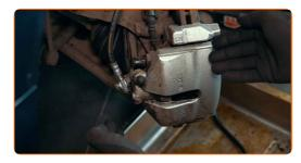
Stellen Sie die Dichtheit des Systems sicher, indem Sie das Bremspedal mehrmals hintereinander betätigen
