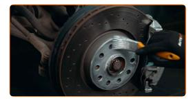
Reinigen Sie die Bremsfläche der Bremsscheibe
