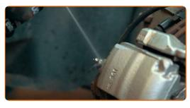
Entlüften Sie das System, indem Sie die Bremsflüssigkeit durch das System pumpen
