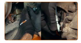
Ziehen Sie das Befestigungselement fest und verlegen Sie den Schlauch so, wie er zuvor verlaufen war
