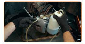
Schrauben Sie zunächst die Entlüftungsschraube etwas heraus
