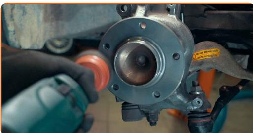
**8** Behandeln Sie den Montagesitz der Trägerplatte mit einem Korrosionsschutzmittel
