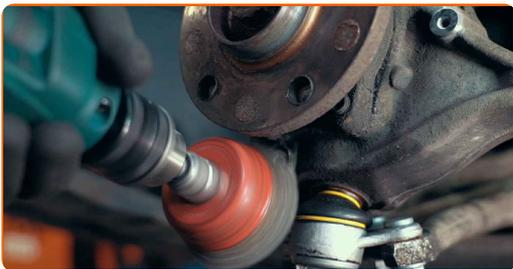
**7** Reinigen Sie die Kontaktfläche zwischen der Radnabe und der Bremsscheibe
