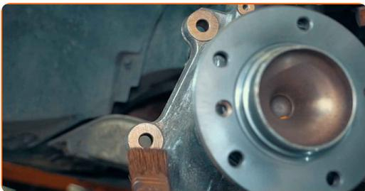
**9** Montieren Sie eine neue Trägerplatte und die Befestigungen
