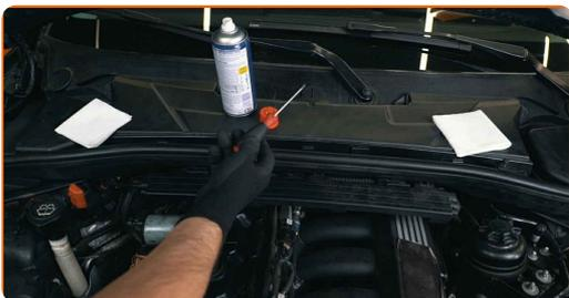
**4** Halten Sie die Motorhaube mit einer Hand fest und hebeln Sie mit der anderen Hand die Klammern der Dämpfer nach oben
