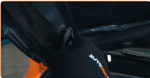
**5** Entfernen Sie den Dämpfer und reinigen Sie die Kugelzapfen
