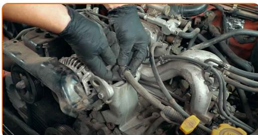
**6** Schrauben Sie die Befestigungselemente der Lichtmaschine ab.
