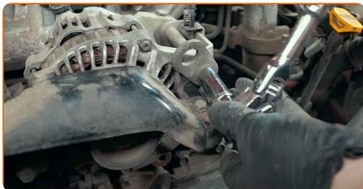
**7** Bauen Sie die Lichtmaschine aus.
