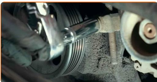
**4** Entfernen Sie den Antriebsriemen der Lichtmaschine.
