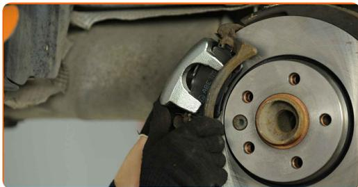
**21** Bringen Sie den Kabelbaum des Bremsbelagverschleißsensors an.
