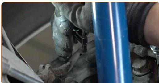
**19** Reinigen Sie die Oberfläche des Bremssattels.
