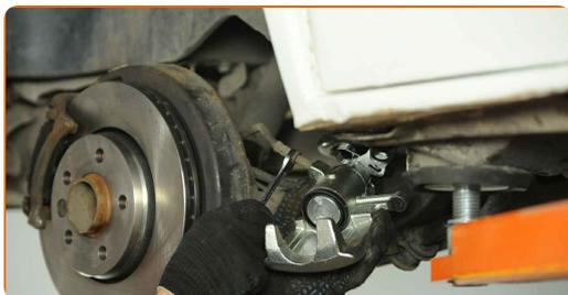
**18** Entfernen Sie die Bremsschlauchklemmen.
